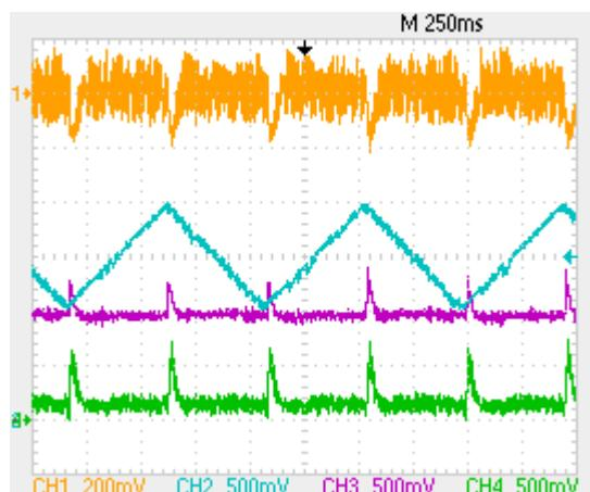
Servo 2: Die Signale des Spitzenwert-Detektors bestätigen, dass praktisch immer kurze Strompulse auftreten. Der Vergleich mit dem gefilterten Strom-Signal zeigt, dass deren Beitrag zum Servo-Strom gering ist. Dagegen spielen sie durchaus eine gefährliche Rolle als Störquelle.
